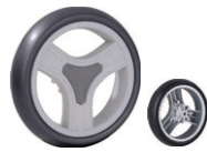
NAME: 5"三菱轮 ITEM NO: XH5009 SIZE: 125*30 配套: 5", 6", 6.5"前, 7", 8"前, 8"后, 10", 10" 备注: 反面带刹车齿
